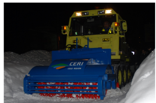
写真-2 雪氷路面処理装置試験状況
