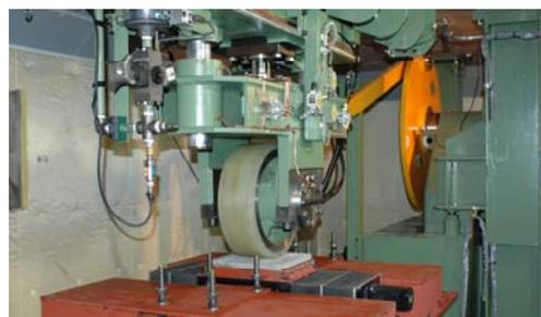
写真-12 凍害用ランダム走行試験機
