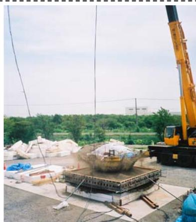
写真-1 緩衝構造に関する屋外大型実験状況
