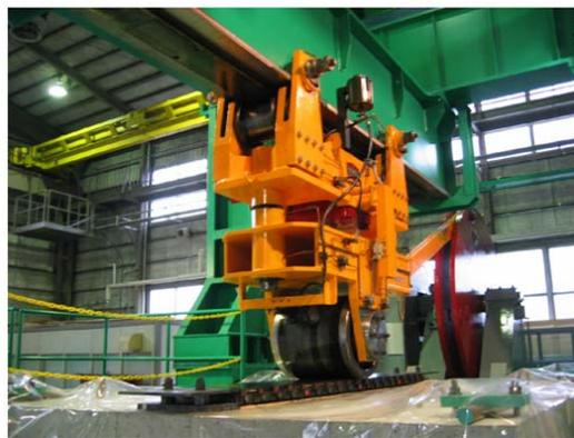
写真-10 輪荷重走行試験機
