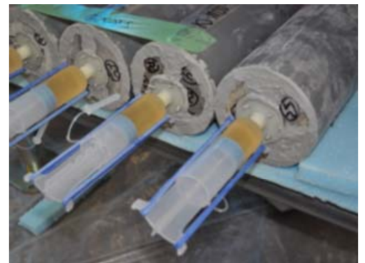
写真-1 樹脂系注入材を用いたひび割れ注入工法
