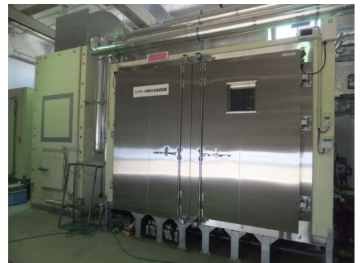
写真－5 コンクリート複合劣化促進試験装置
