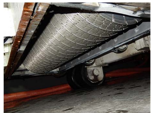
写真-2 ダイヤモンドグラインディングの研削ブレード
