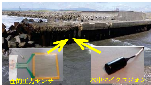
図-3 水中マイクロフォンと面的圧力センサーを用いた砂礫の衝突音と衝突力計測システムのイメージ
