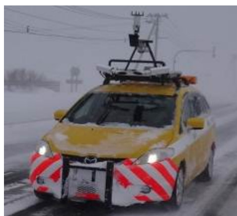
図-3 視程障害移動観測車
