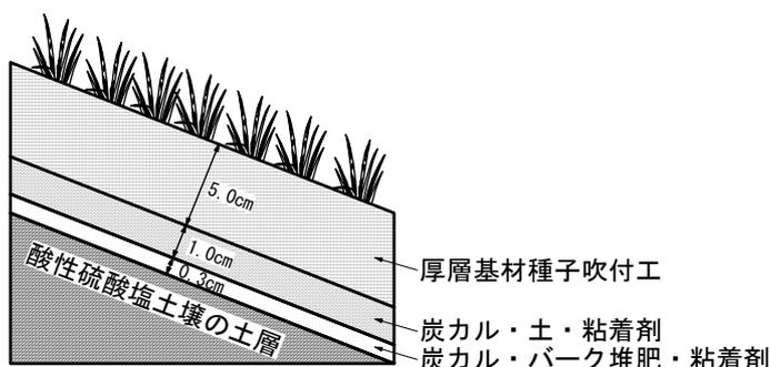
図-1 中和工法断面模式図
