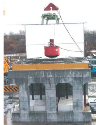
写真-2 1/2 縮尺ロックシェッド模型を用いた衝撃実験状況
