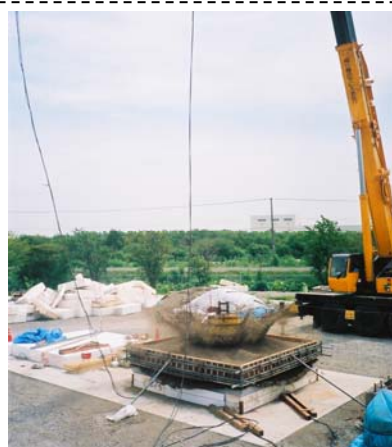
写真-1 緩衝構造に関する屋外大型実験状況
