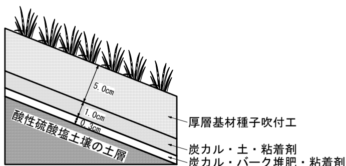
図-1 中和工法断面模式図
