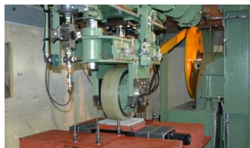
写真-12 凍害用ランダム走行試験機
