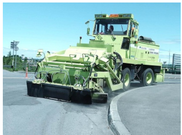
写真－2 ロータリ除雪車を通年活用するためのアタッチメント式路面清掃装置（北海道開発局で導入）
