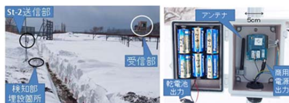
写真-15 検知センサ、データ送信部 (試作)
