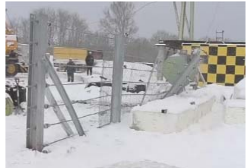
写真－5 既設落石防護柵の実験状況
