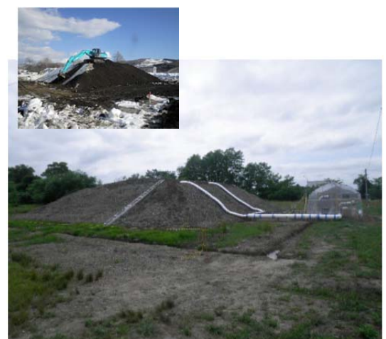
写真-3 バーク材で被覆した実験用の雪山
