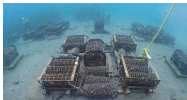
図-7 試験礁の設置状況（水深-4m）
