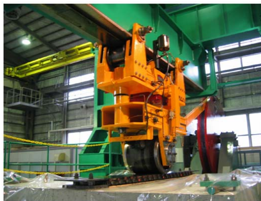
写真-10 輪荷重走行試験機
