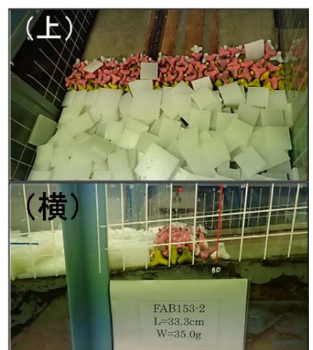
写真-6 被災相当波浪作用後の状況
