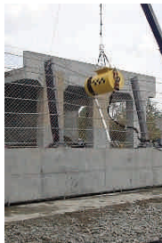
落石防護柵の実規模衝突実験
