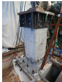
橋脚の耐震性能実験
