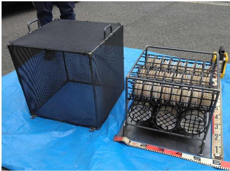
図-3 ホタテ基質を用いて空隙を最適化した高生残率、高成長を支える内部構造
