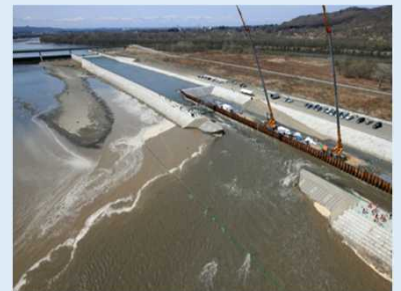
実物大規模の越水破壊実験
