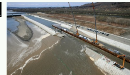
実物大規模の越水破堤実験
