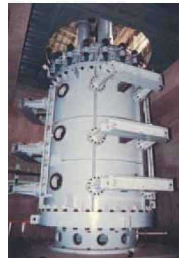
超大型三軸圧縮試験機
