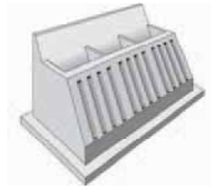
斜面スリット堤
