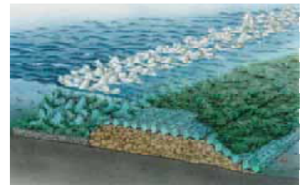
複断面傾斜堤イメージ
