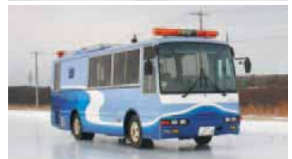
凍結防止剤・すべり止め材の散布効果試験 (上：一般交通を模した車両の走行、 下：路面のすべり摩擦係数を測定する測定車)
