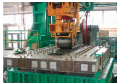
新形式合成頂版の輪荷重走行試験状況
