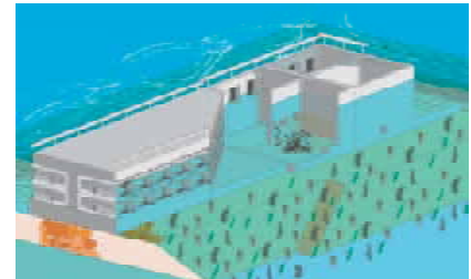
生け簀付ケーソン概念図（温根元漁港）
