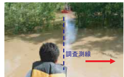
ラジコンボートを用いた、洪水時の樹木群内流況観測の様子
