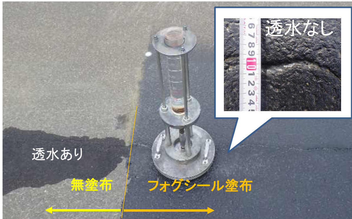
フогシールの遮水性評価試験例
