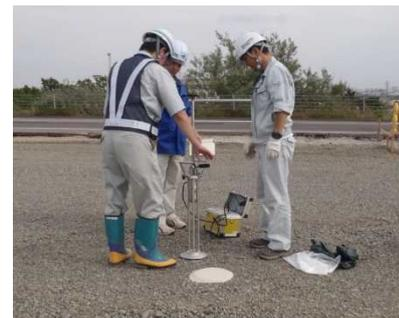
衝撃加速度装置 測定状況
